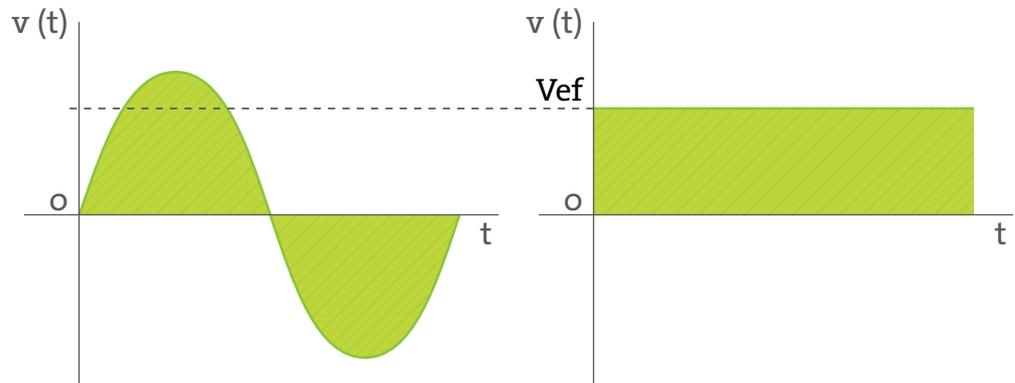
**EL VALOR EFICAZ:** es un parámetro que se utiliza para caracterizar formas de onda y se define como el valor de tensión continua que sería capaz de suministrar la misma potencia (a un elemento del circuito que disipa toda la potencia que se le suministra), que la potencia que le proporciona la forma de onda con dicho valor eficaz. En la siguiente ecuación tenemos la expresión matemática del valor eficaz.
